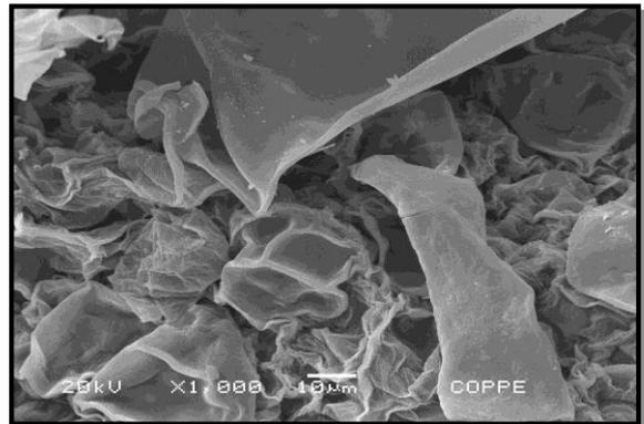
**Figura 26:** MEV do biosorvente MBOH 1000x ampliada após contato com solução de Pb (II) 100mg L<sup>-1</sup>
