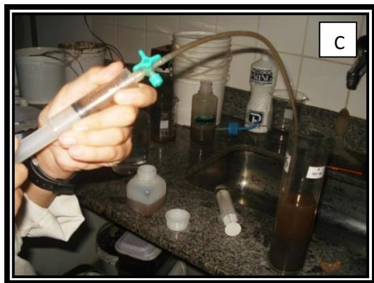
Figura 7: A) Uso de seringa e agulha para retirada de alíquotas de ar (*headspace*); B) Microcosmos montados e fechados para início da incubação; C) Retirada de água com auxílio de seringa e mangueira após a incubação para análises CID e  $p\text{CO}_2$ .
