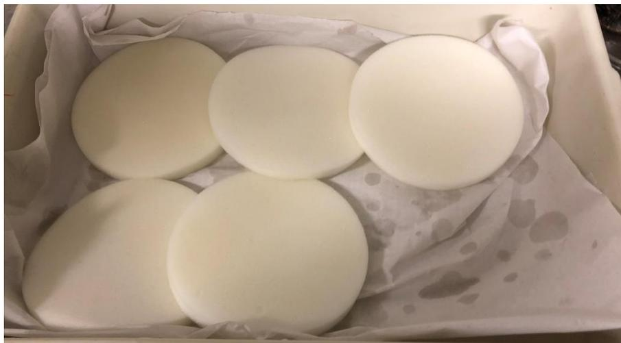
Figura 6: Discos de espuma de poliuretano após serem lavados em água corrente no processo de preparação das amostras (Foto: Camilla Szerman).
